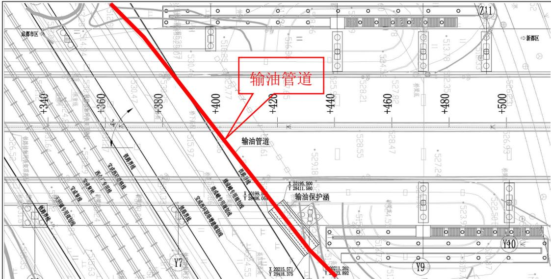
图 53 本项目与兰成渝输油管线位置关系见下图
